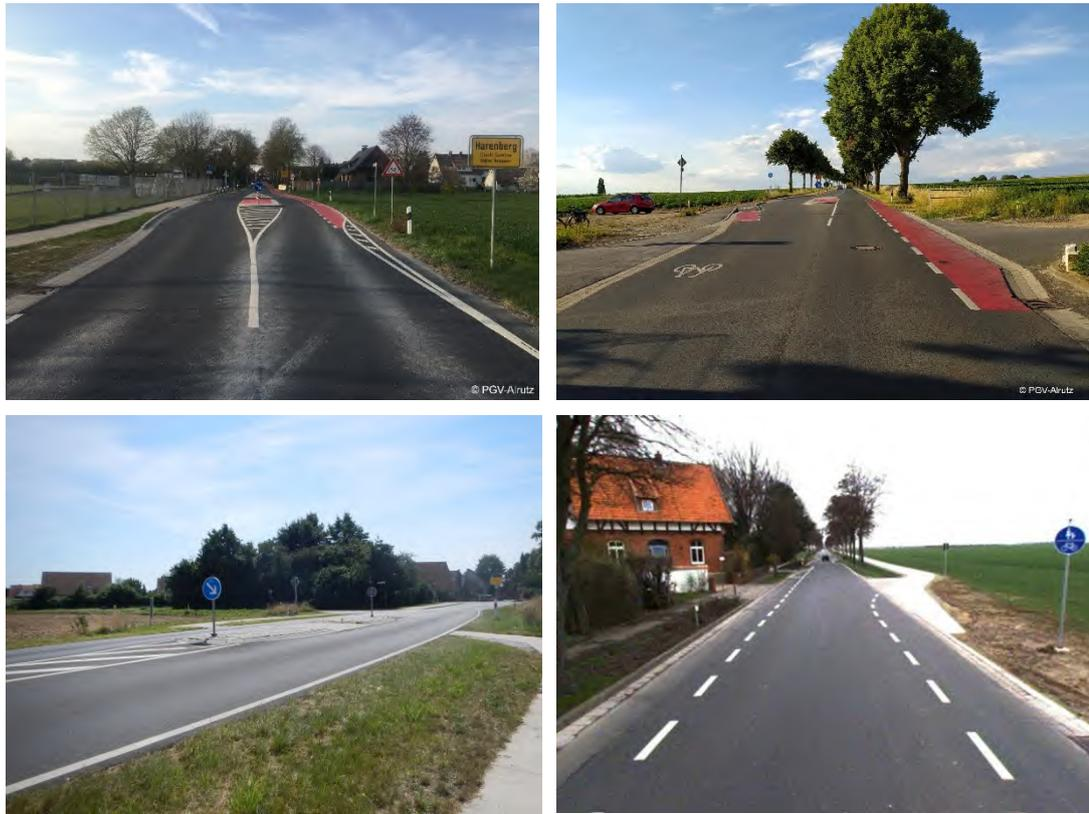
Abb. 7-4: Beispiele zur Gestaltung eines Ortseingangs mit Überführung des Radverkehrs von einseitiger Führung im Seitenraum außerorts in die richtungstreue Führung innerorts (Region Hannover)
