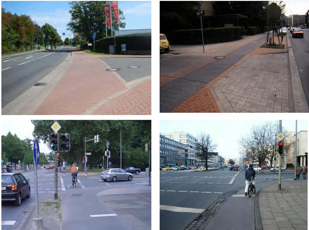
Abb. 7-5: Aufgepflasterte fahrbahnahe Radverkehrsfurt, aufgepflasterte Radwegüberfahrt, signalisierter Knoten innerorts mit eigenem Radsignal, signalisierter Knoten mit Raumvorlauf für den Radverkehr (alle Region Hannover)
